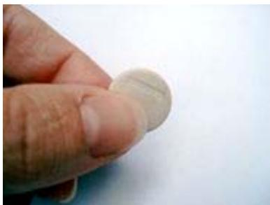
El chip ARIO 370-DL de TAGSYS está especialmente pensado para lavanderías industriales, hospitalarias y para el sector de la hostelería en general. Conforme a la normativa ISO 15693. El chip está garantizado por 200 lavados, presión de hasta 35 bares, es resistente a productos químicos, altas condiciones de humedad y a elevadas temperaturas, perfectamente adaptados a las temperaturas de las calandras existentes en el mercado.
